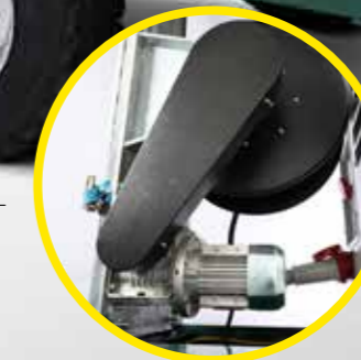
Sistema di movimentazione elettropompa
